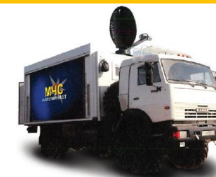
Мобильный комплекс информирования и оповещения населения на шасси автомобиля КАМАЗ
